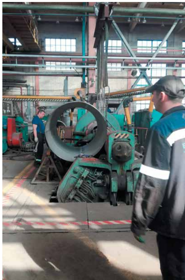
Рулонирование обечайки футеровки (АО «Невинномысский Азот»)
