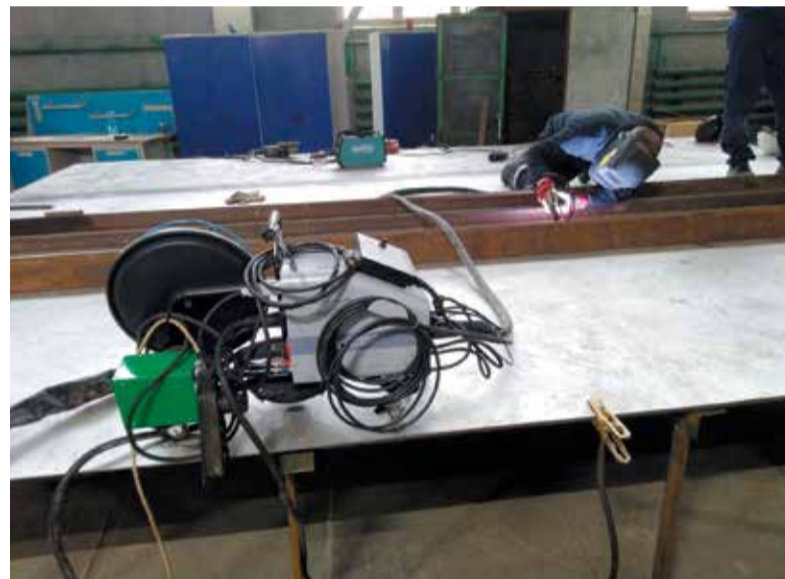
Аргонодуговая сварка. Заготовка будущей футеровки реактора с механизированной подачей сварочной проволоки (АО «Невинномысский Азот»)
