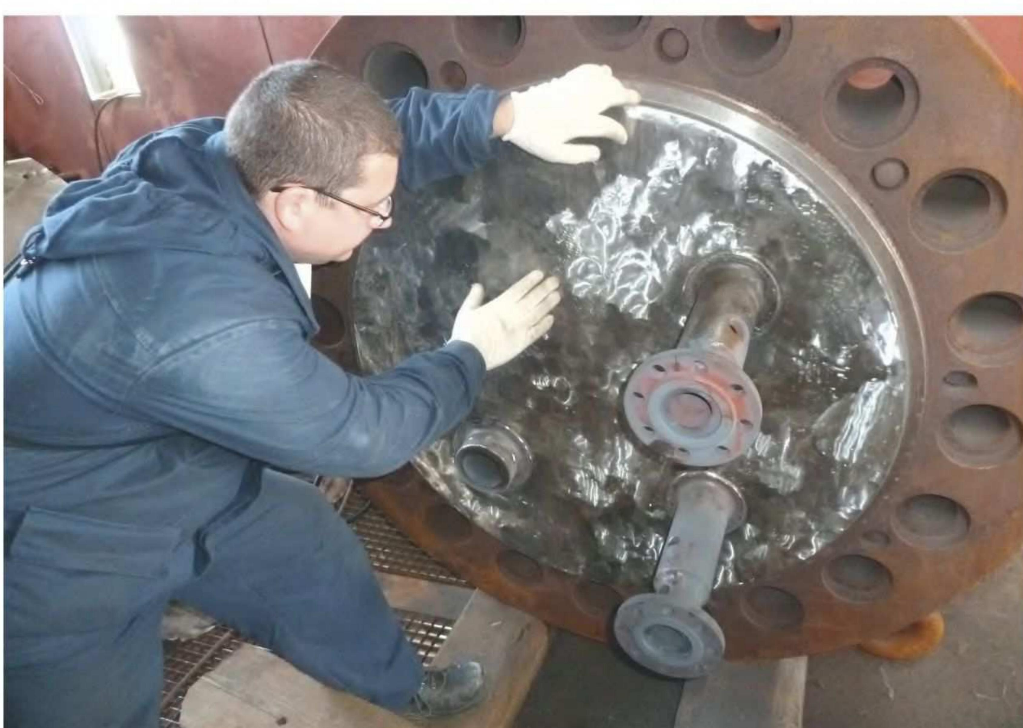
Визуальный осмотр футеровки крышки колонны синтеза
