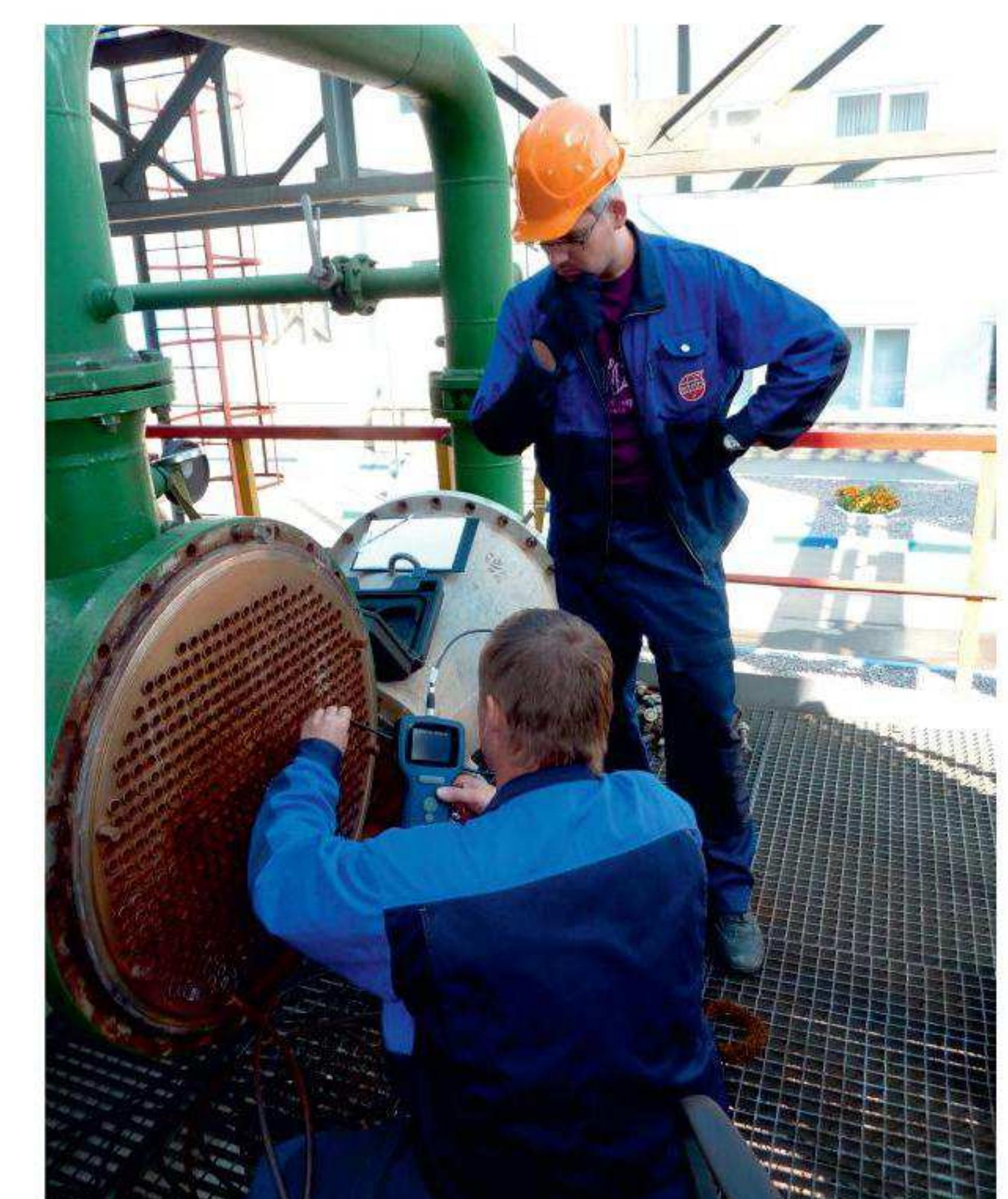
Обследование видеоэндоскопом внутренней поверхности теплообменных труб на ОАО «НАК «Азот»
