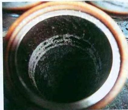
Рис. 5. Язвы на внутренней поверхности теплообменных трубок стриппера поз. Е-201
