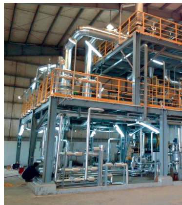
Полукommerческая установка СБГ для производства сложных удобрений. Завод Phu My, Вьетнам
