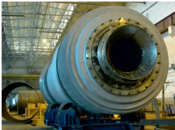
В 2011 году ОАО НИИК заключил договор с КАО «Азот» (г. Кемерово) на поставку двух скоростных барабанных грануляторов общей производительностью 500 т/сутки. Установка была смонтирована на базе существующего корпуса с демонтажем неиспользуемого оборудования.
