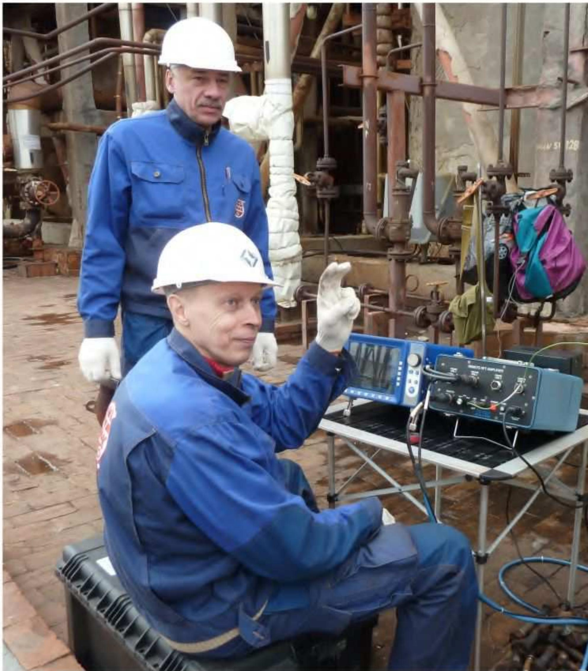
**ОАО «Невинномысский Азот», цех уксусной кислоты – вихревая дефектоскопия теплообменника**
