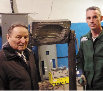
Рис. 2. Наплавка контрольного образца
