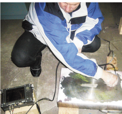
Рис. 3. Проведение неразрушающего контроля
